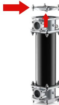
1. Smontare il coperchio svitando le quattro viti di fissaggio
