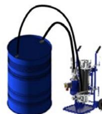
In Serbatoio: Per pulire l'olio in un serbatoio, si consiglia di filtrare più volte l'olio contenuto all'interno dello stesso. In questo caso inserire e posizionare le lance di aspirazione e di mandata nel serbatoio. Dove possibile è consigliabile filtrare con l'impianto funzionante così da poter ricircolare e filtrare anche l'olio presente al di fuori del serbatoio: tubazioni, blocchi valvole, cilindri, motori idraulici, ecc.
