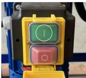
Ad operazioni concluse, spegnere l'unità di filtrazione agendo sull'interruttore di spegnimento "0" e disinserire la spina di collegamento elettrico.
