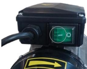
Lorsque les opérations sont terminées, éteignez l'unité de filtration à l'aide de l'interrupteur '0' et débranchez la fiche de connexion électrique.
