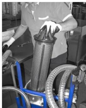
Svitare il dado di fissaggio inferiore, sfilare il distanziale e quindi l'elemento filtrante intasato. Montare l'elemento filtrante pulito, infilare il distanziale e serrare il dado a battuta. Infilare l'elemento ed il suo supporto nel corpo filtro, richiudere il coperchio e serrare i 4 dadi di fissaggio.
